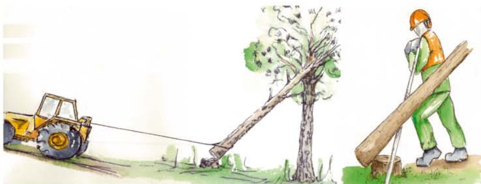
Fig 10. Formas seguras de apearse un árbol enganchado. Izquierda, cable y tractor. Derecha. Uso de palanca. Al realizar el esfuerzo se mantendrá la espalda recta.
