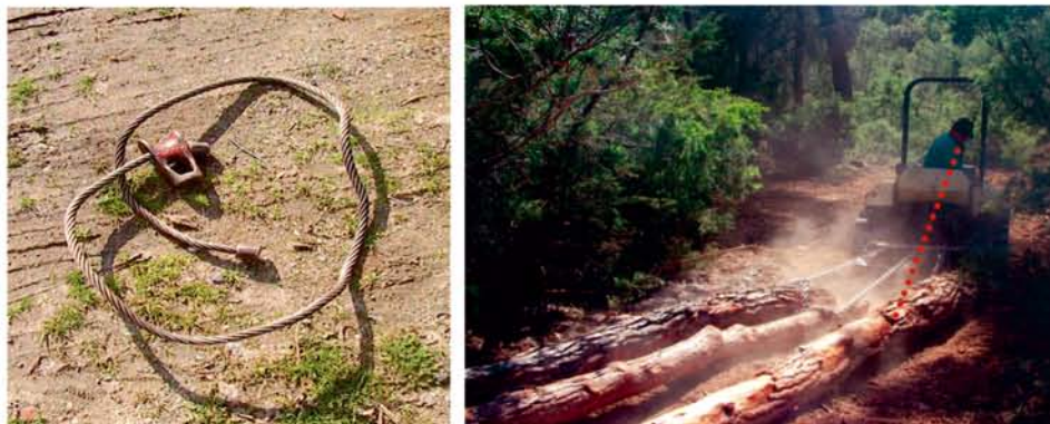
Fig 49. Izquierda eslinga y chóker, derecha, operario vigila el arrastre.
