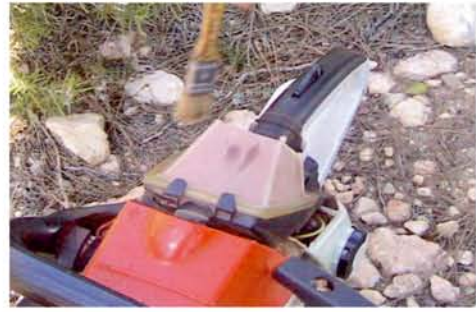
Fig 35. Limpieza filtro del aire.
