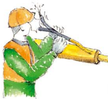
Fig. 43. Antes de manipular el sistema hidráulica se parará el motor.
