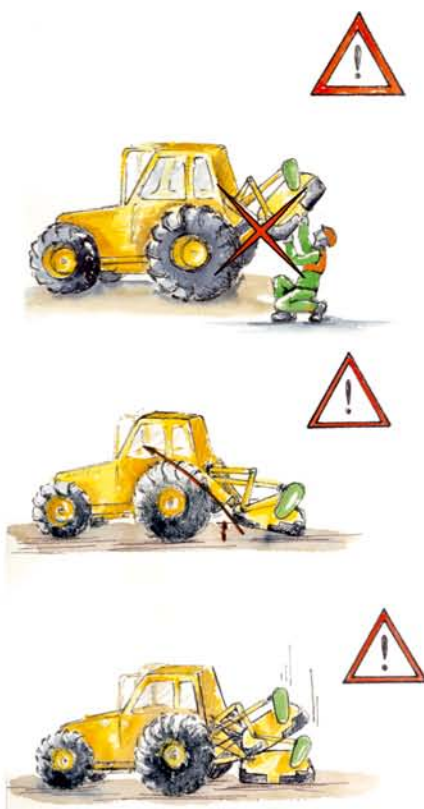
Fig 73. Arriba. Ningún operario se colocará debajo del apero suspendido por el tractor. Centro. La altura del apero será lo más baja posible para evitar las proyecciones. Abajo. No se bajará bruscamente el apero de altura.
