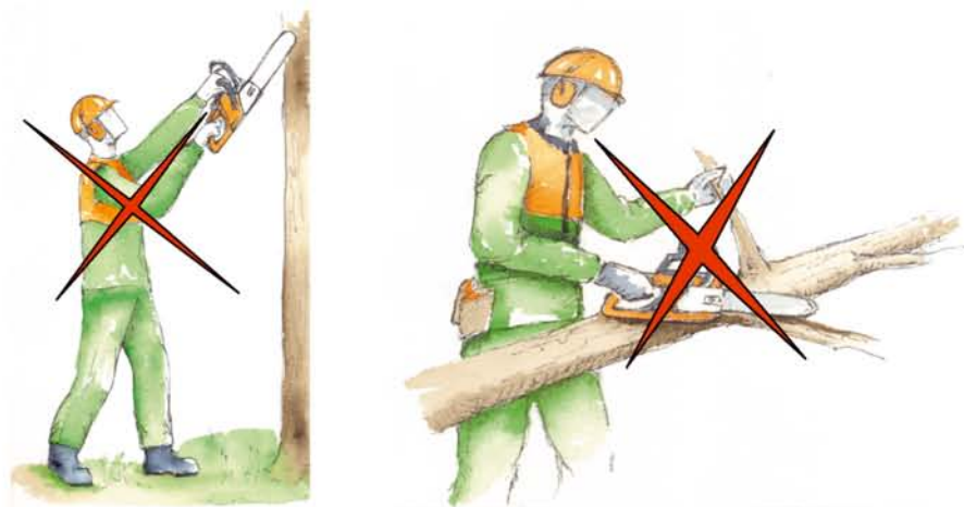
Fig 33. Acciones con la motosierra muy peligrosas
