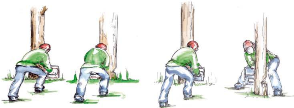
Fig 8. Dos alternativas para hacer un apeo con dos cortes, el de dirección y el de caída.
