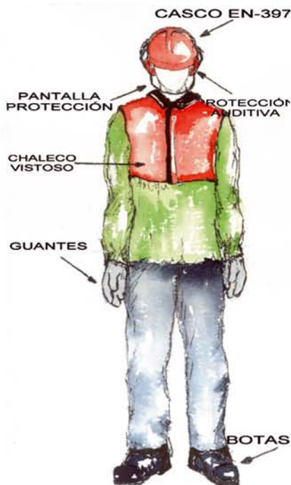
Fig 30. Equipo de protección individual.
