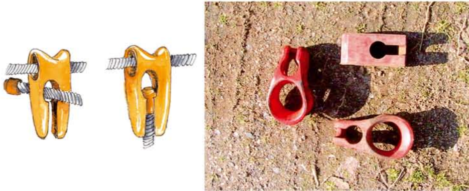
Fig 48. Izquierda, forma de enganchar el cable y chóker y derecha tres chókers.
