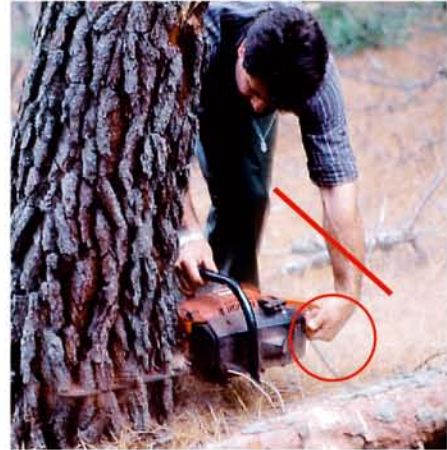
Fig 13. Operario sin Equipo de Protección Individual, en posición forzada, con ropa inadecuada.
