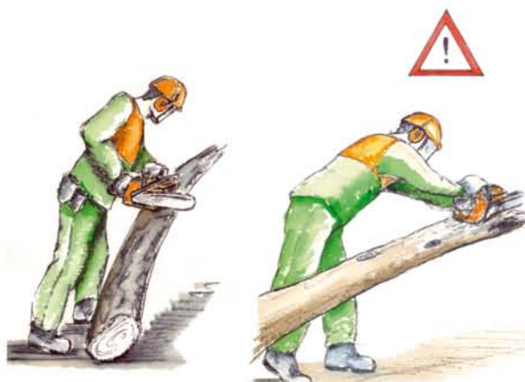
Fig 13. En la figura de la izquierda se observa como el/la motoserrista apoya el peso de la máquina en el fuste y dispone las piernas ligeramente abiertas y flexionadas. En la figura de la derecha la posición es forzada resultando dañina para la espalda y peligrosa en caso de rebote o resbalón.
