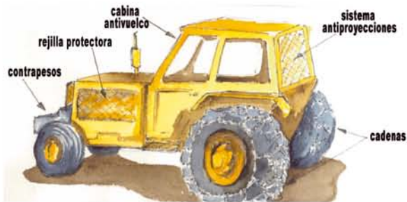
Fig 44. Adaptaciones del tractor agrícola para uso forestal.
