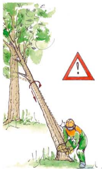
Fig 9. Uno de los riesgos de los árboles enganchados es el retroceso que se puede producir.
