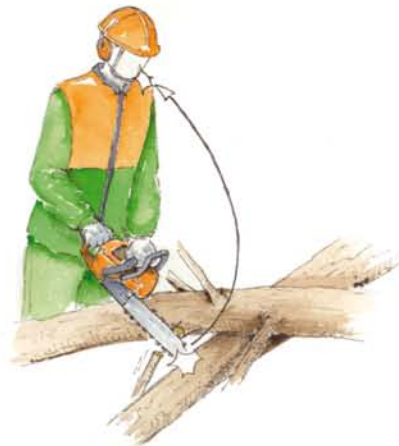
Fig 31. Peligroso rebote de la motosierra por colisión de la punta con un fuste.
