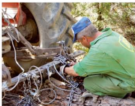
Fig 47. Cables en mal estado, enrolladores inseguros.
