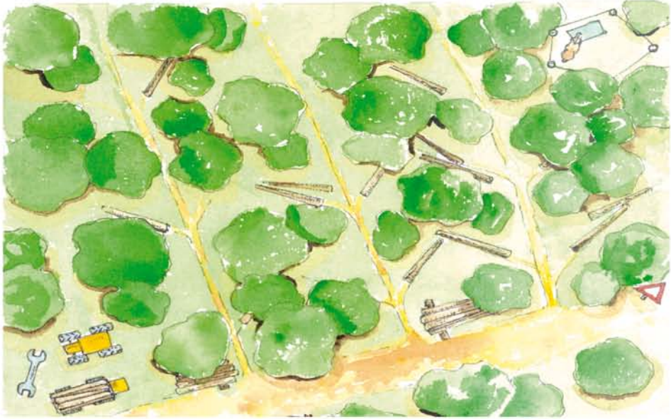
Fig 5. Zona de trabajo organizada: zona de reparación de máquinas, señalización, arrastraderos o trochas distribuidas homogéneamente, concentración de los fustes apeados.
