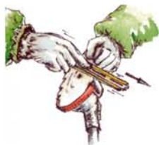
Fig 62. Afilado de la cuchilla de corte.
