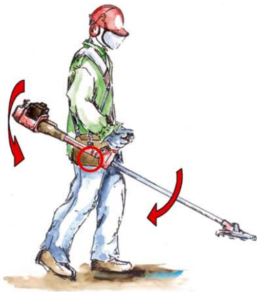
Fig 64. La motodesbrozadora debe estar equilibrada
