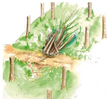
Fig 26. Cargadero inapropiado en la red de drenaje secundaria
